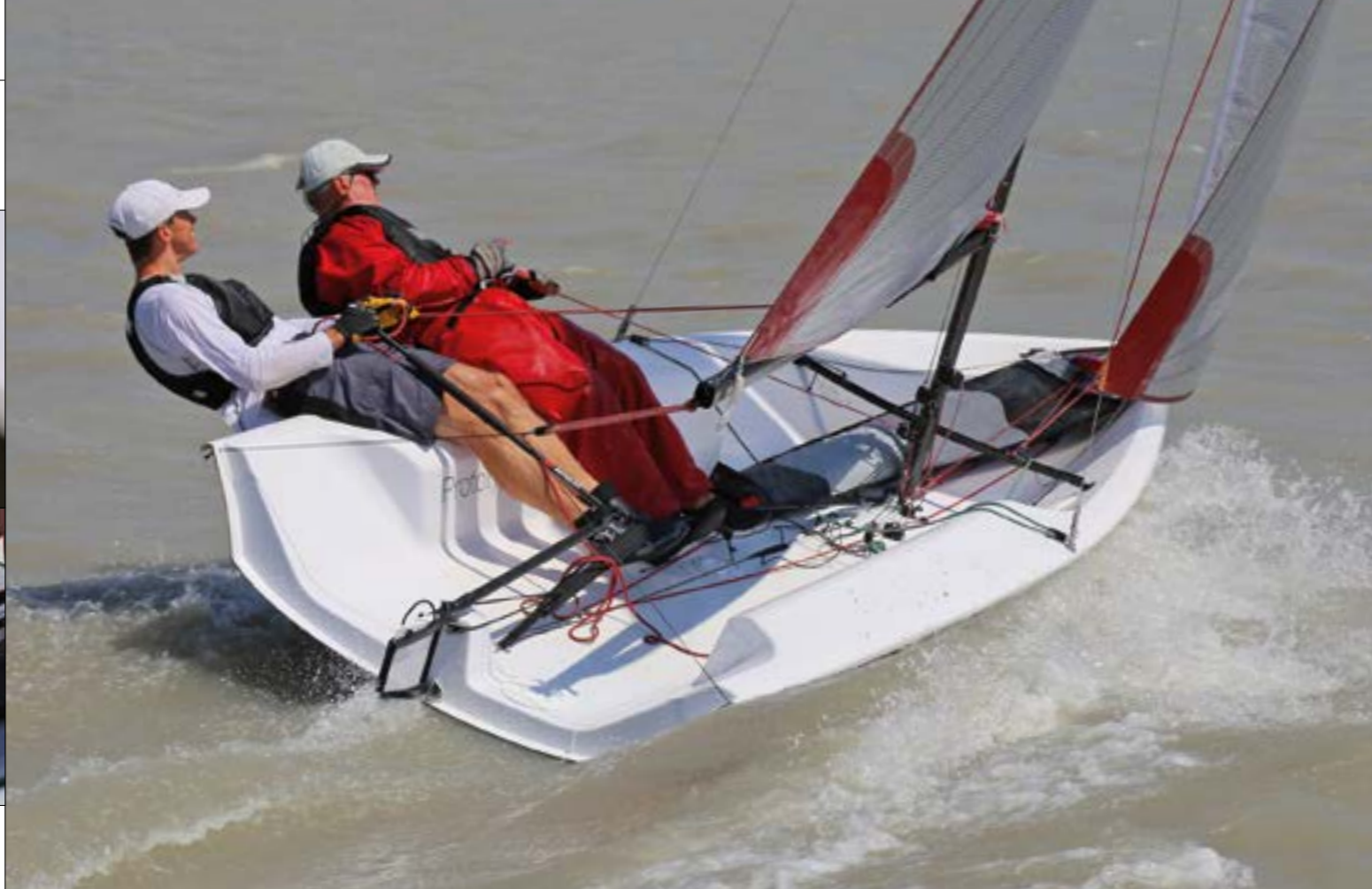
Durchdacht. Ein Slipwagerl gibt es als Option, man kann die Räder aber auch direkt an den Rumpf schrauben. Die Selbstwendefock leistet vor allem gute Dienste, wenn man solo unterwegs ist
