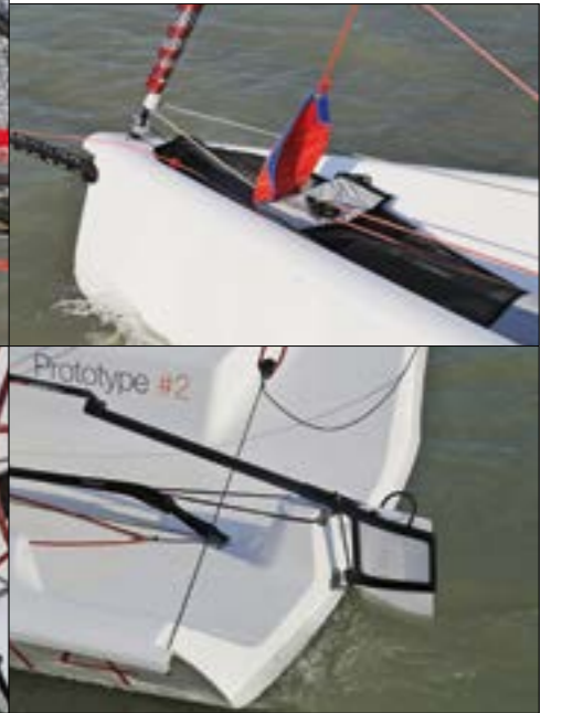
Funktionell. Statt eines Niederholers gibt es einen Niederdrücker, der Gennaker lässt sich via Einleinsystem bedienen. Die hintere Schwertposition wird verwendet, wenn man nur mit dem Groß segelt, das Steckruder ist feinfühlig, die Cockpitergonomie passt für Segler aller Größen
