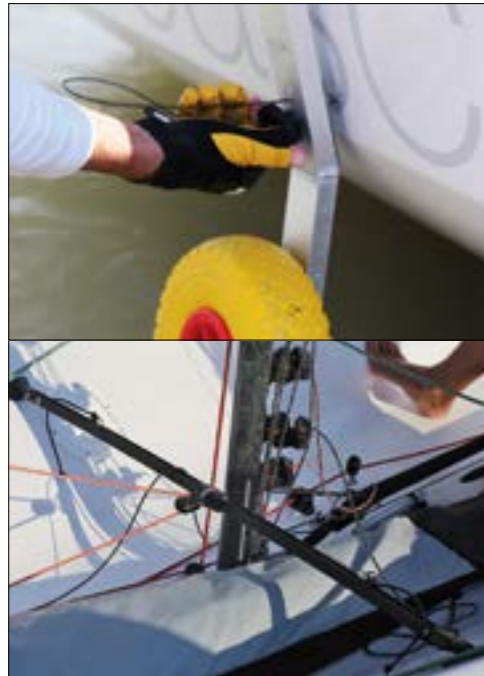
Durchdacht. Ein Slipwagerl gibt es als Option, man kann die Räder aber auch direkt an den Rumpf schrauben. Die Selbstwendefock leistet vor allem gute Dienste, wenn man solo unterwegs ist
