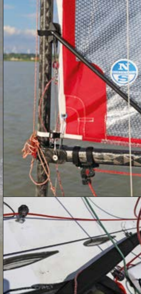
Funktionell. Statt eines Niederholers gibt es einen Niederdrücker, der Gennaker lässt sich via Einleinsystem bedienen. Die hintere Schwertposition wird verwendet, wenn man nur mit dem Groß segelt, das Steckruder ist feinfühlig, die Cockpitergonomie passt für Segler aller Größen
